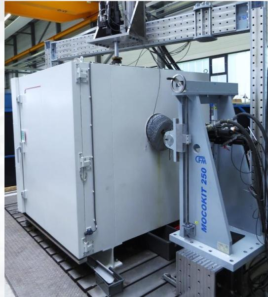
3- bzw. 4-axiale Prüfung von Blattfedern unter Klima
