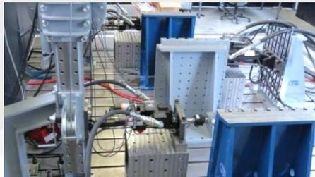
1-axiale Prüfung von FLCA
