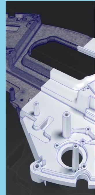
Rückführung von Scandaten in ein CAD-Modell zur Herstellung von Ersatzteilen oder Rekonstruktion defekter Bauteile
