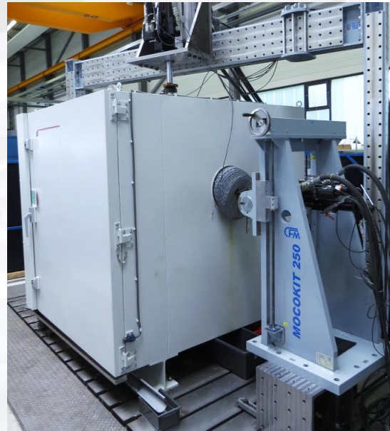
3- bzw. 4-axiale Prüfung von Blattfedern unter Klima
