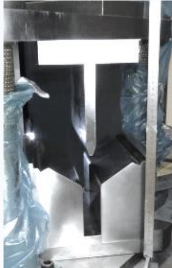
3-Punkt-Biegeprüfung asymmetrischer Profile
