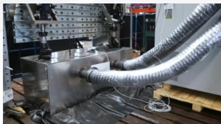
2-axiale Prüfung von Stabilisatoren unter Klima
